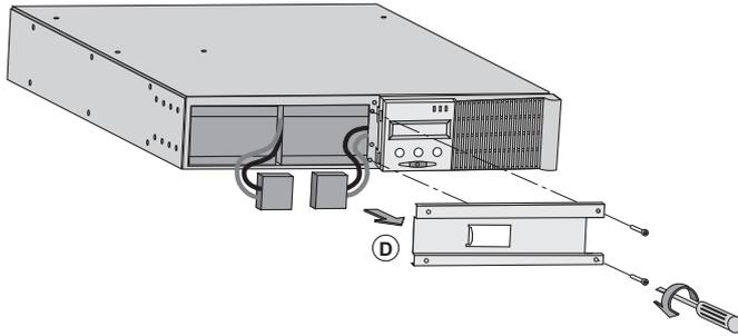
**D** - Rimuovere il coperchio metallico di protezione della batteria fissato da 2 viti.
