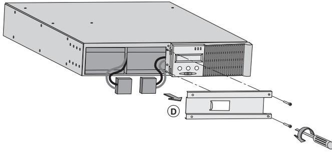
**D** - Quitar la cubierta metálica de protección de la batería fijada con 2 tornillos.
