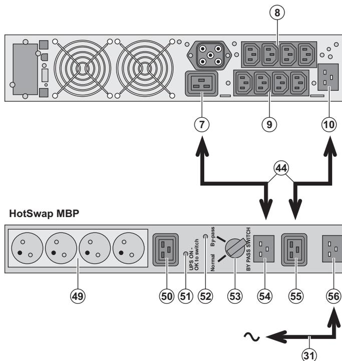
La funzione del modulo **HotSwap MBP** è quella di consentire la manutenzione ed eventualmente la sostituzione dell'ASI senza interferire sull'alimentazione elettrica delle apparecchiature collegate (funzione **HotSwap**).
