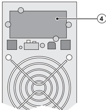
Plaatsing van de communicatiekaart, met beperkte toegang.
