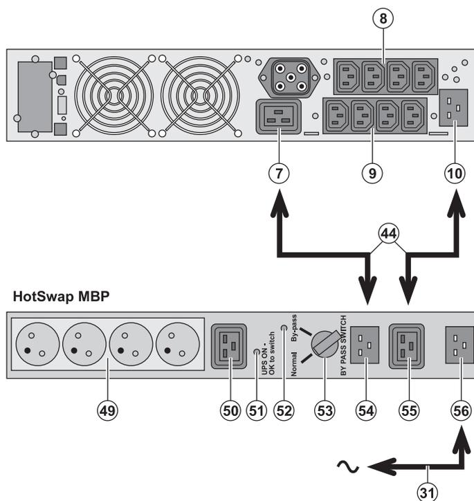
Блок HotSwap MBP обеспечивает техобслуживание и, при необходимости, замену АБП таким образом, чтобы это не повлияло на электропитание соединенного с ним оборудования (функция HotSwap).
