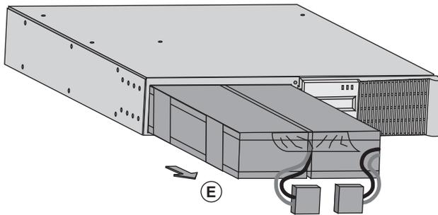
**E** - Trek aan de plastic lip om het accublok uit het toestel te halen en vervang het accublok.
