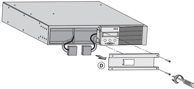
**D** - Batterie-Schutzabdeckung entfernen (Schrauben).
