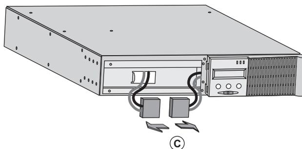
C - Batteriemodul durch Lösen der 2 Steckverbinder abklemmen (nicht an den Kabeln ziehen!)
