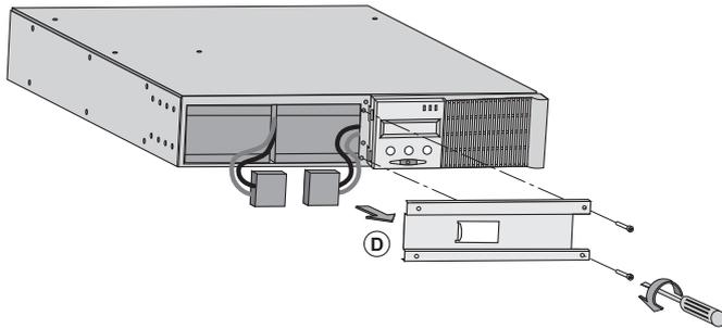
Г - Снять защитную металлическую крышку батареи, отвинтив 2 винта.
