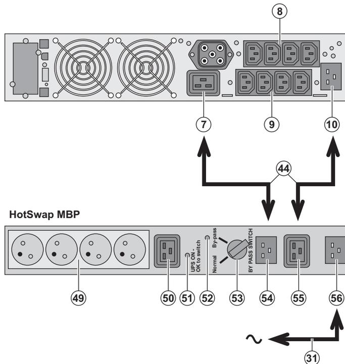
La función del módulo **HotSwap MBP** es permitir el mantenimiento y, eventualmente, la sustitución del SAI sin que ello afecte a la alimentación eléctrica de los equipos conectados (función **HotSwap**).
