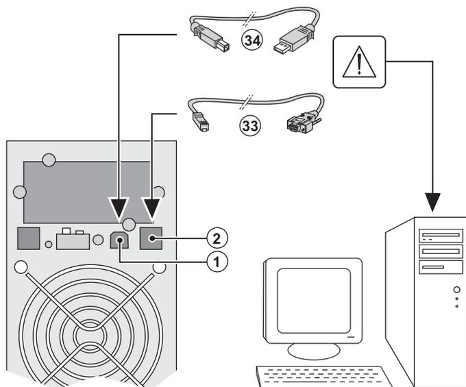
1 - Kabel (33) oder (34) an die RS232- bzw. USB-Schnittstelle des zu schützenden Rechnersystems anschließen.
