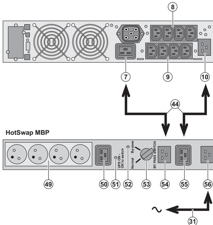
Das **HotSwap MBP**-Modul ermöglicht die Wartung und ggf. den Austausch der USV, ohne die Spannungsversorgung der angeschlossenen Verbraucher unterbrechen zu müssen (**HotSwap**-Funktion).
