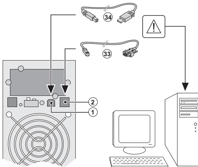
1 - Conectar el cable de comunicación RS 232 **(33)** o USB **(34)** al puerto serie o USB del equipo informático.
