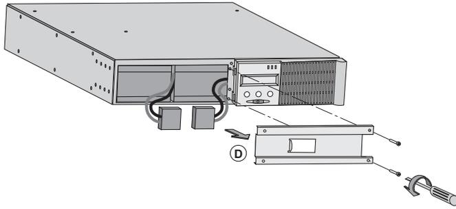
**D** - Verwijder de metalen beschermkap van de accu. Deze is met 2 schroeven bevestigd.
