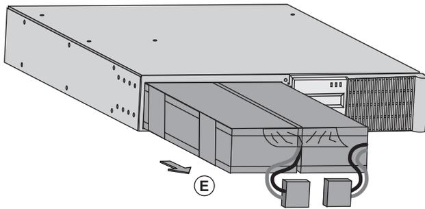
**E** - Batteriemodul durch Greifen der Kunststoffflasche herausziehen und durch neues ersetzen.
