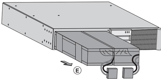
**E** - Extraer el bloque de la batería tirando de la lengüeta de plástico y proceder a su sustitución.
