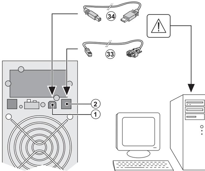
1 - Sluit de RS 232-communicatiekabel (**33**) of de USB-communicatiekabel (**34**) aan op de seriële of USB-poort van de computerapparatuur.
