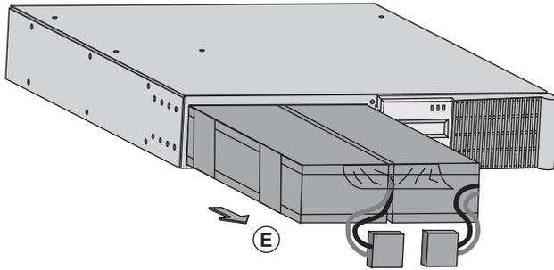
**E** - Estrarre il gruppo batteria tirando sulla linguetta di plastica e procedere alla sostituzione.
