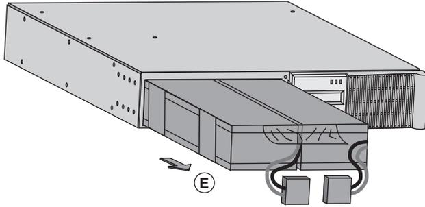
**E** - Extraire le bloc batterie en tirant sur la languette plastique et procéder à son remplacement.
