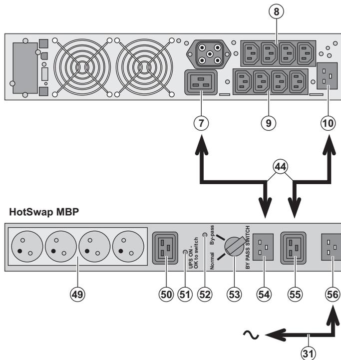
Le rôle du module **HotSwap MBP** est de permettre la maintenance et éventuellement le remplacement de l'ASI sans affecter l'alimentation électrique des équipements connectés (fonction **HotSwap**).
