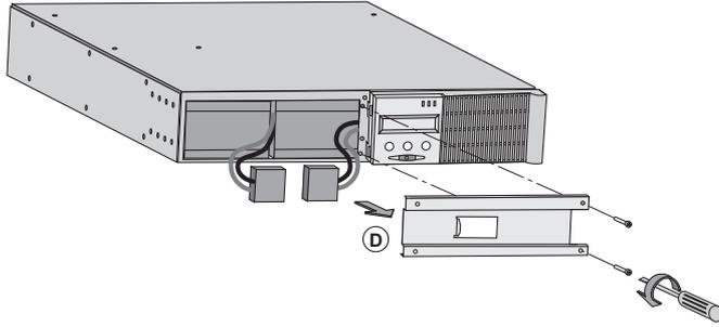
**D** - Enlever le capot métallique de protection batterie fixé par 2 vis.
